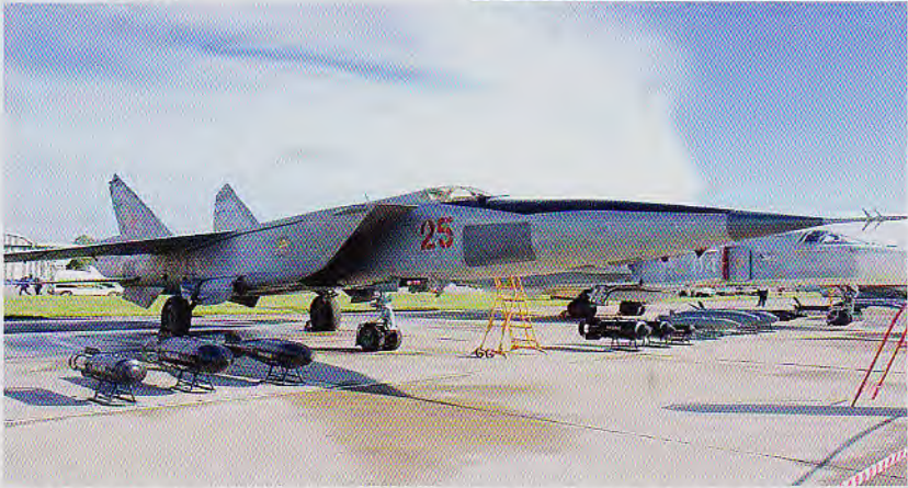
ሚ.ግ 25 ሕ.ሶቪት ነበር ክሳብ 3000 ኪ.ሜ አብ ሰዓት ክትበርር እትኸእል ናይ ውግእ ነፋሪት 15.1.3*
